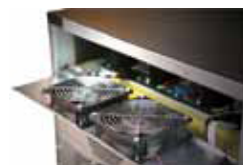
Резервирование вентилятора повышает надежность системы*
